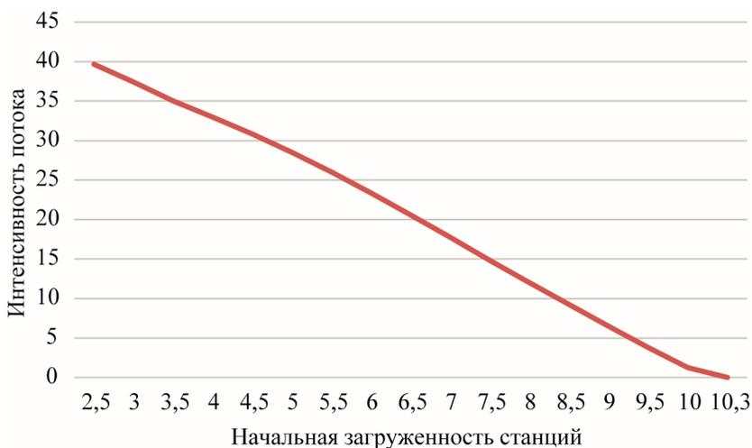
**Рис. 65.** График зависимости интенсивности стационарного потока от начальной загруженности станций
